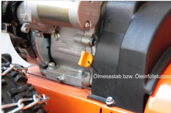
Öffnen Sie den Öldeckel und befüllen den Öltank mit Motorenöl (5W40 / 10W40). Benutzen Sie hierzu den mitgelieferten Trichter.
