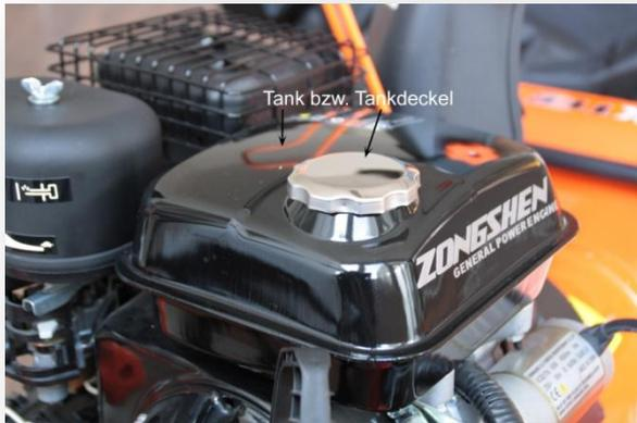
Öffnen Sie den Tankdeckel und befüllen Sie den Tank mit Super Benzin (E5) oder E10.
