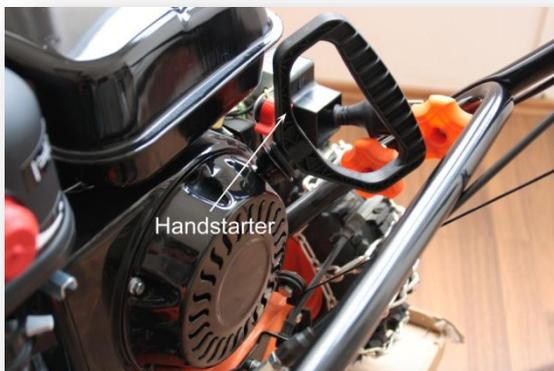
Handstarter bzw. Handgriff ziehen (Bei Schneefräse 5,5PS und 6,5PS)
